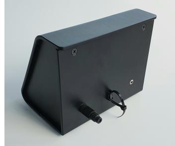
Der Mithör-Lautsprecher MHL kann über einen Standard-Klinkenstecker z.B. an einen PC angeschlossen werden. Die Spannungsversorgung des MHL erfolgt über einen Gleichspannungseingang mit einer beliebigen Spannung zwischen 18 V und 57 V. Die Polung ist dabei nicht zu beachten.
